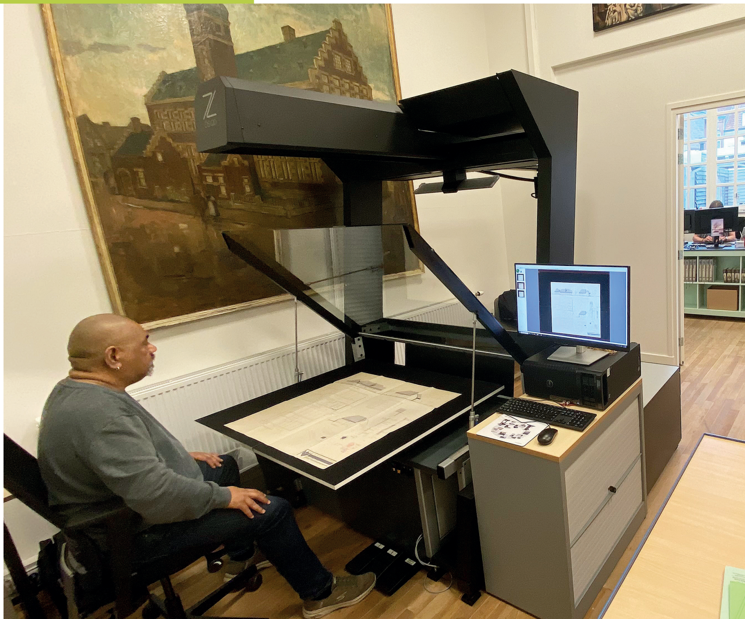
De A0 scanner, geplaatst in een voormalig deel van de studiezaal.
